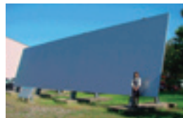
LNGを収納するタンクに 使用されるアルミニウム板材 板厚60×幅4,030×長さ16,350(mm)
