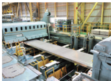
歪みのない平坦な 大型厚板の製造を可能にする 国内最大のストレッチャー
