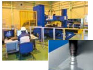
FSW(摩擦攪拌接合)装置
