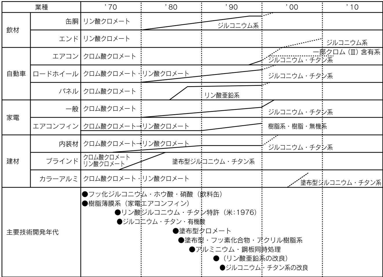
図2 ノンクロメート化への移行状況と主要技術の開発状況 Fig.2 Transition to non-chrome type pretreatments and development of major technologies.
