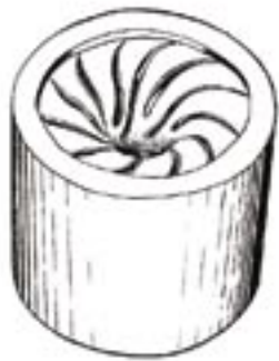
(マスターモデルに電鍍メッキの後、マスターモデルを溶解)
