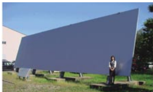
写真の板サイズ: 板厚60×幅4,000×長さ16,000 (mm)
