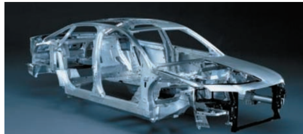
b) スペースフレーム構造 (A8/Audi)
