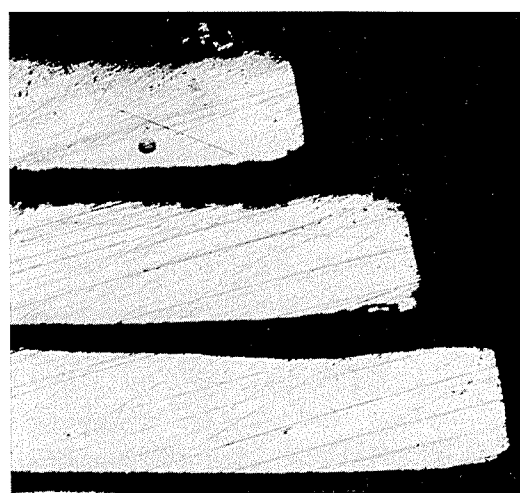
写真5 WM, Gruber Equipment 社製トランス用箔のエッジ
