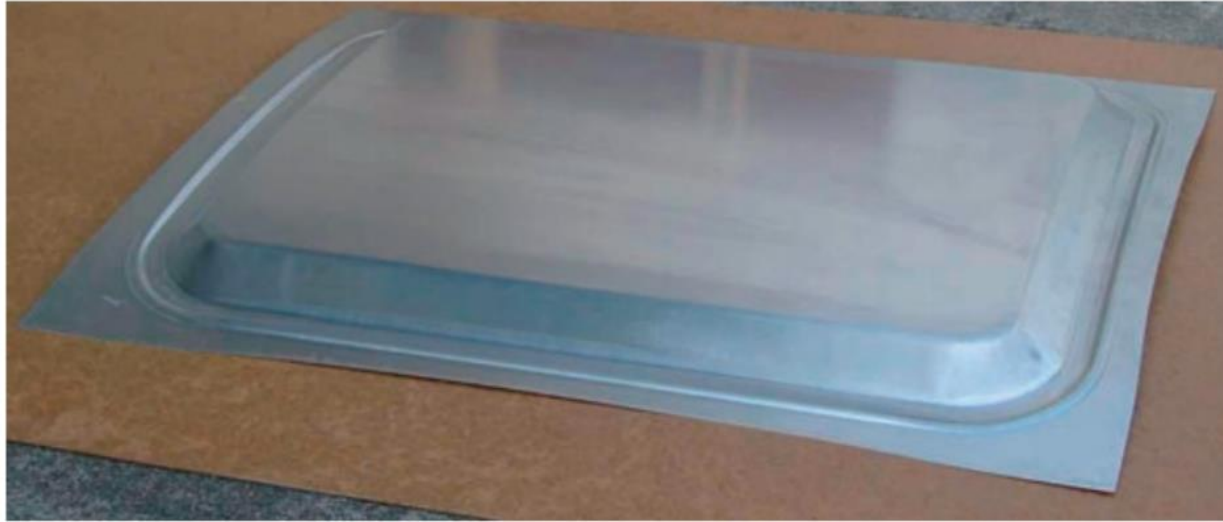
図1 6000系開発合金板の実験プレス成形品
