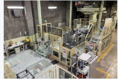
縦型高速双ロール鋳造実験機(R&Dセンター:名古屋)
