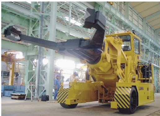
図2 鍛造素材ハンドリング用マニプレータ Fig. 2 Manipulator for forged material handling.
