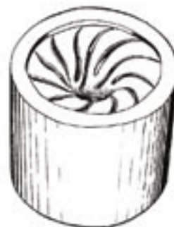
(マスターモデルに電鑄メッキの後、マスターモデルを溶解)
