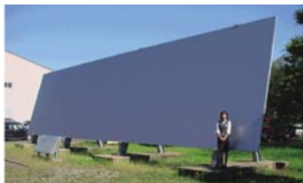
写真の板サイズ: 板厚60×幅4,000×長さ16,000 (mm)
