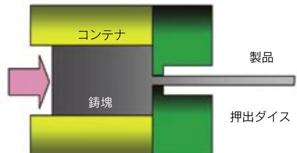
図3 押出加工の概略
