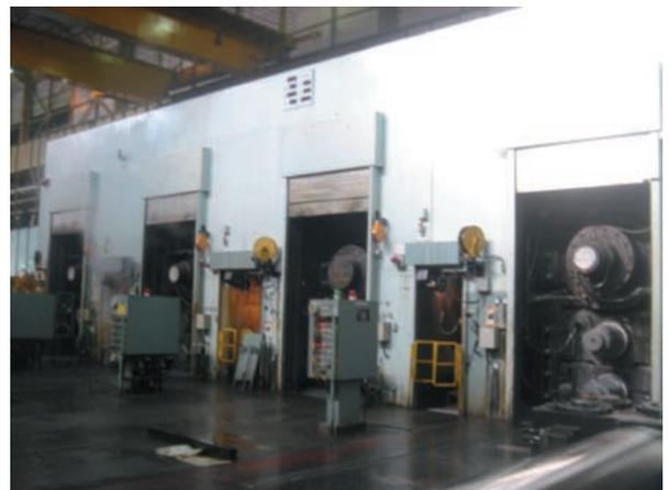
図7 仕上げタンデム圧延機
