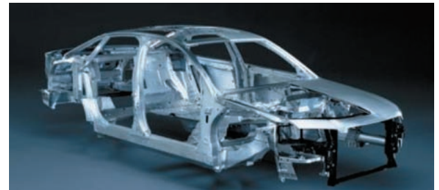
b) スペースフレーム構造 (A8/Audi)
