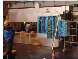
図4 プロフィールメータ外観(設置前)
