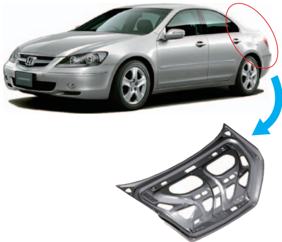
図5 ホンダレジェンドと高温ブロー成形されたトランクリッドインナー Fig.5 High-temperature blow-formed trunk lid inner of the Honda Legend.
