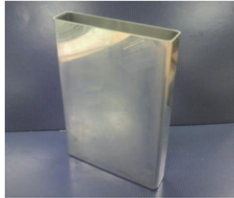
図1 電池ケース用材の成形後外観例
