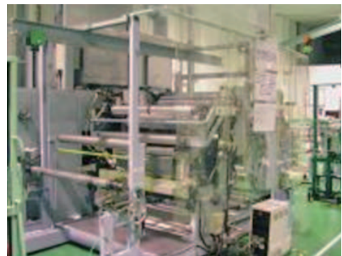
図5 ワックスラミネーター機 Fig.5 Wax laminate machine.
