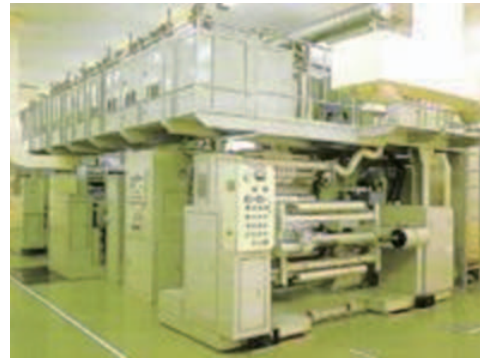
図4 ドライラミネーター機 Fig.4 Dry laminate machine.
