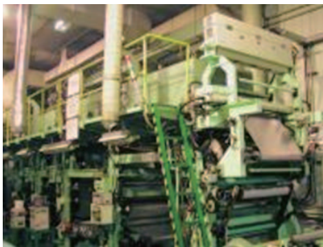
図2 グラビア印刷機 Fig.2 Photogravure printing machine.
