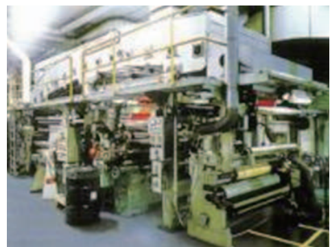
図6 ウェットラミネーター機 Fig.6 Wet laminate machine.
