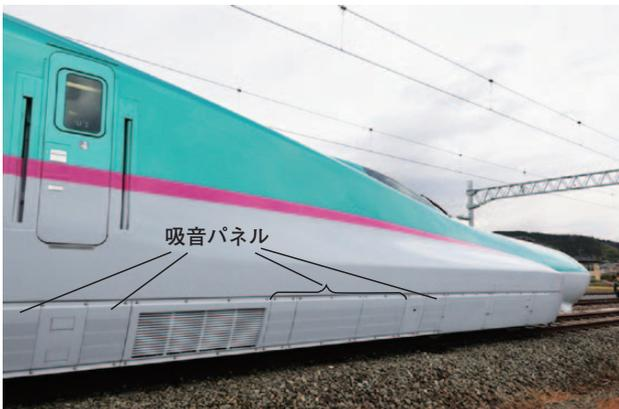
図1 E5系の吸音パネル
