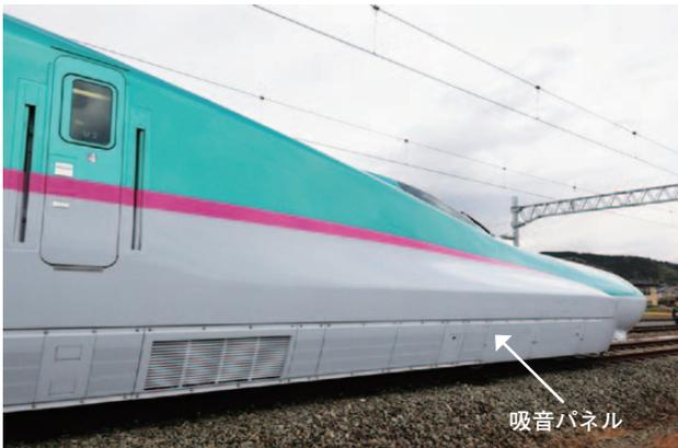
図1 吸音パネルの使用状況
