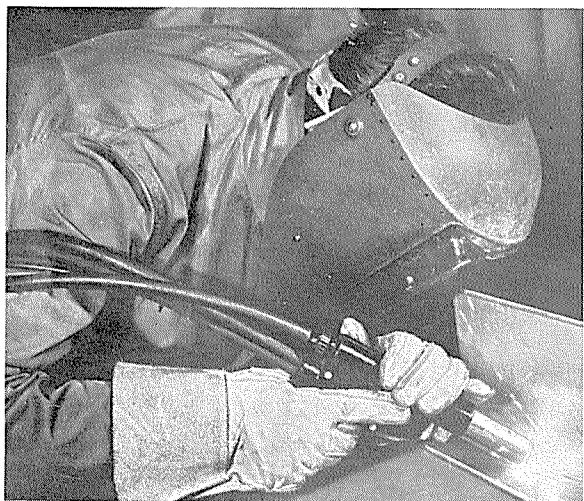
写真13 半自動MIG溶接の作業状況
