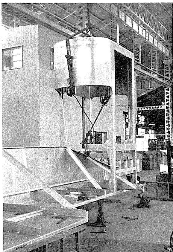
写真 33. 運転室取付の寸法出し
