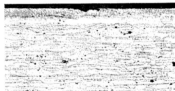
写真 68 外板腐蝕部の断面顕微鏡組織,  $\times 100 \times \frac{1}{2}$
