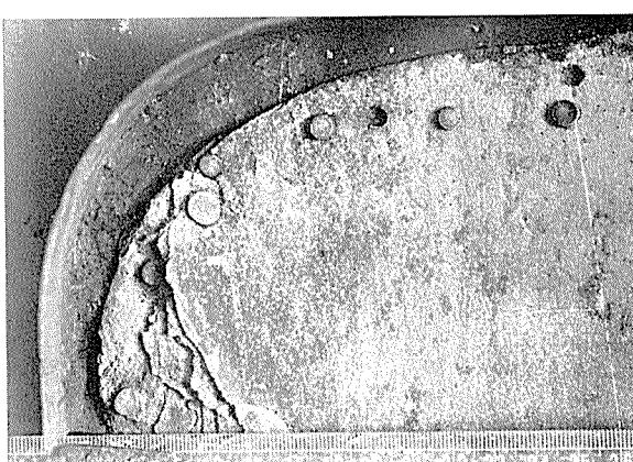
写真 66 側板外板下部（番号⑤）の非大気暴露面の外観（5-3, 塗料剥離後）
