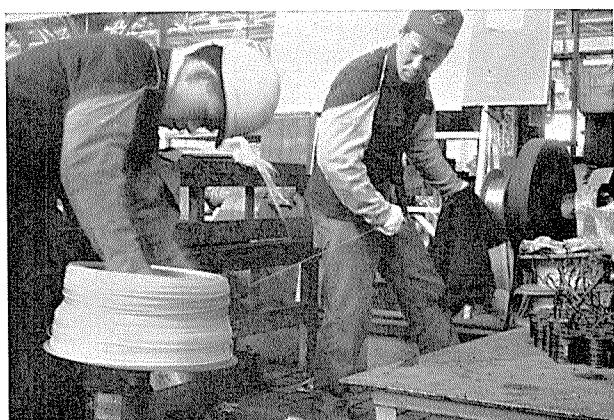
写真21 溶加材の巻取作業
