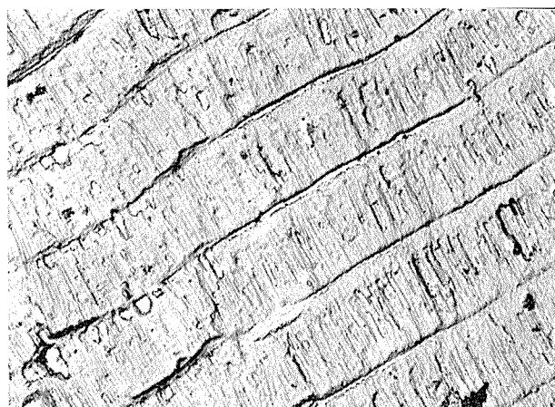
写真3 断続電解法（1分電解、1分休止）で生成した皮膜の断面の電子顕微鏡写真（撮影広沢ら）×9625
