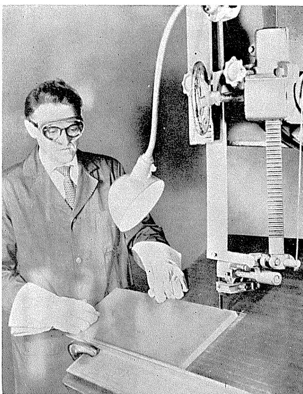
写真5 バンド・ソーによりアルミニウム板の開先加工を行なっているところ
