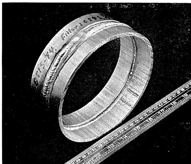
写真4 TIGにより突合せ溶接されたアルミニウム・パイプ
