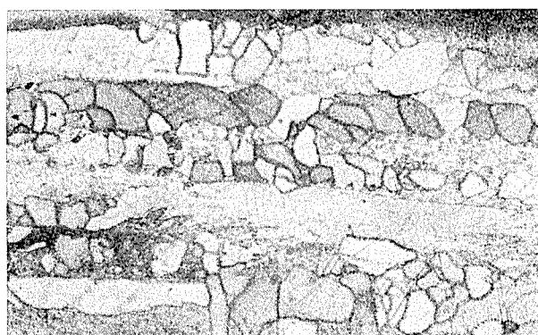
に対し、500°Cの予備処理を行わずに直接250°Cで20min溶体化処理後焼入レを行ったものは0.05mm程度の小さな再結晶粒、あるいはまだわずかに加工組織を残存する。すなわち加工により増殖された転位はまだ多く残っている状態である。この場合ZnのG.P.Zone形成速度は500°Cの予備処理を行い、結晶粒度を大きくしたものにくらべ著しく遅いのが認められる。
