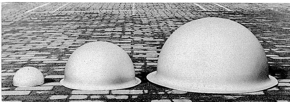
写真 2 爆発成形によるチタニウム合金半球
