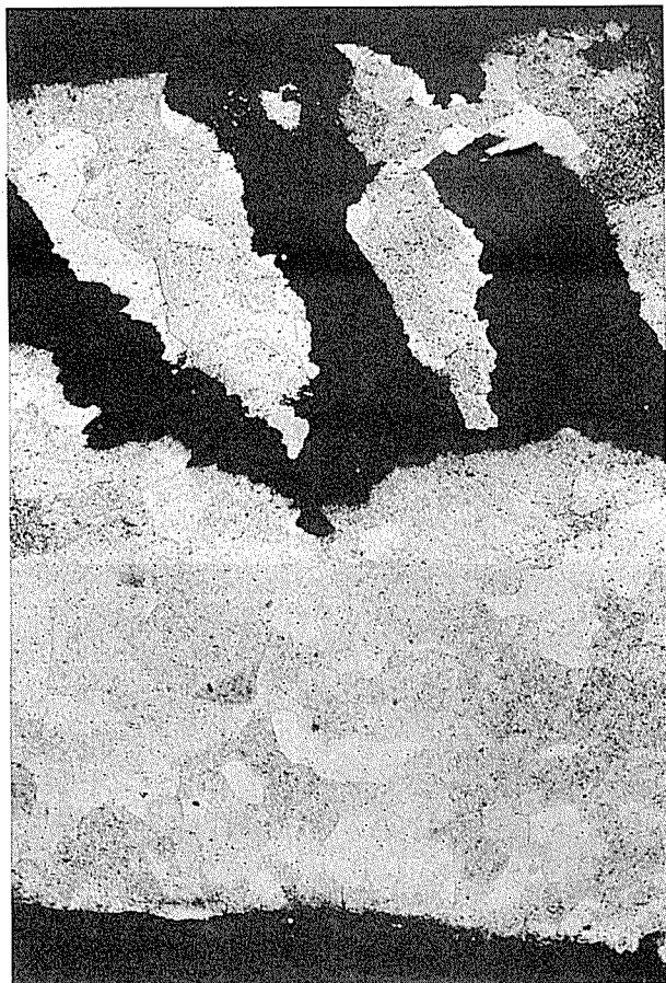
写真1 99.78% アルミニウム管の外面に 100 ppm (塩化第2水銀の形) 程度の水銀を含んだ蒸気による腐食。
