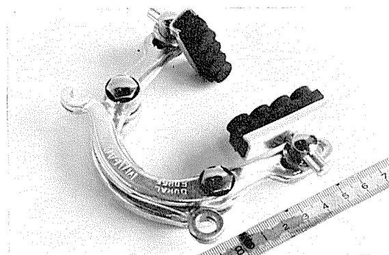
写真10 Mafac 製ブレーキ外観
