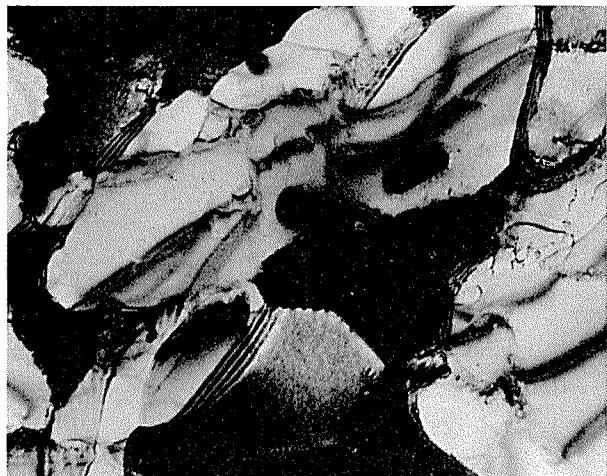
Photo. 5 50% 压延材 (200°C) の電顕組織  $0.5\mu$
