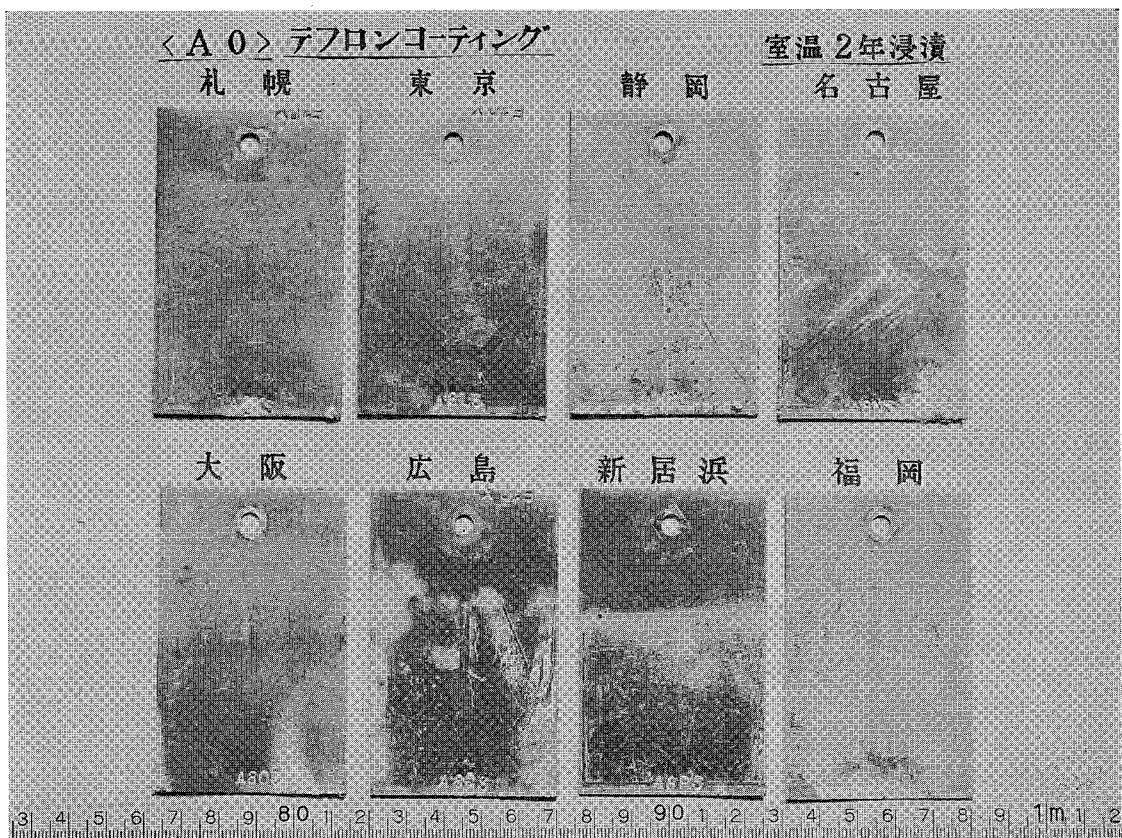
図16 AO テフロンコート材室温試験後の外観状況
