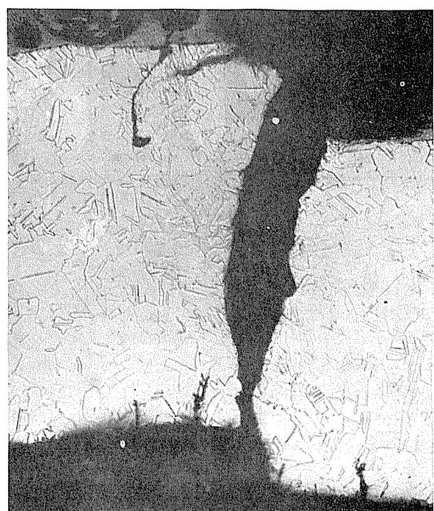
Photo. 6 ガス瞬間湯沸器において、缶胴へ点付けろう接された銅管に熱応力が繰返し作用したために、疲労破壊をきたした銅管の内面および断面状況
