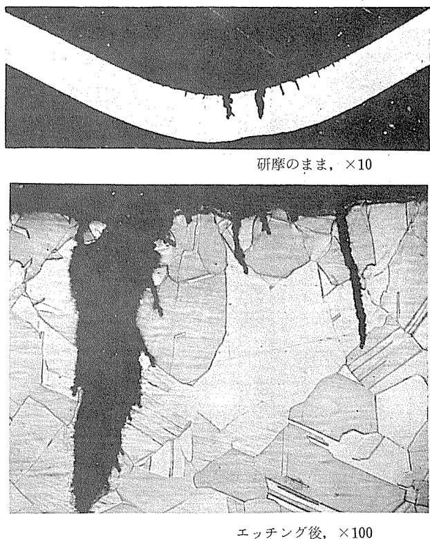
**Photo. 10** 排水用銅管の接続継手として用いられ座屈ならびに腐食疲労割れを生じた銅管製継手の外観と断面状況
