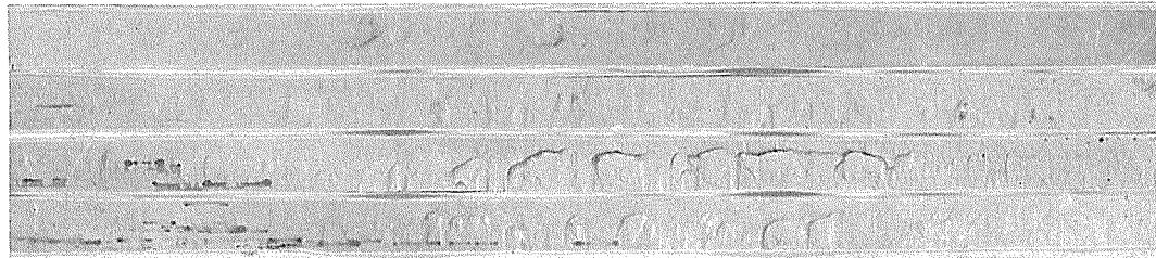
図 5 シャー切断後クロム酸溶液で煮沸し、シャー面に生じた割れの程度（表 4～6 参照）
