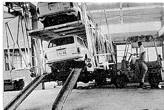
図 5 後輪持上げ試験状況
