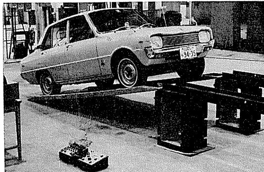
図10 道板の実車載荷試験
