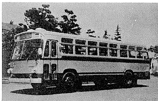
図1 アルミニウム合金製バスの外観
