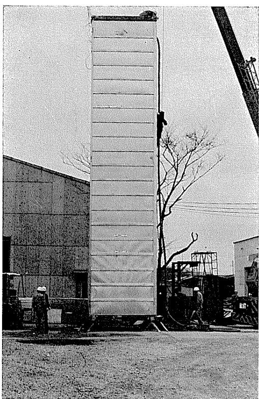
図9 端壁強度試験
