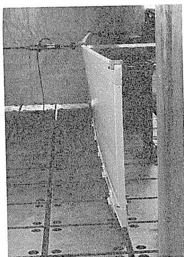
図18 アッパレール中央集中荷重試験状況
