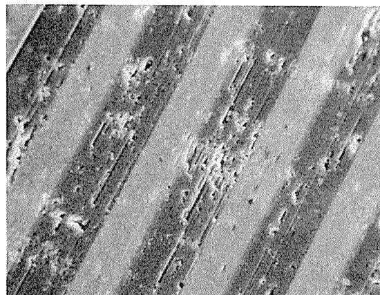
図3 AC5A鉄物の精密切削加工面の走査電顕写真 ( $\times 300$ )
