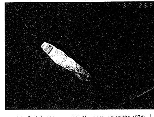
(d) Dark field image of FeAl3 phase, using the (024) 0.5 μm
