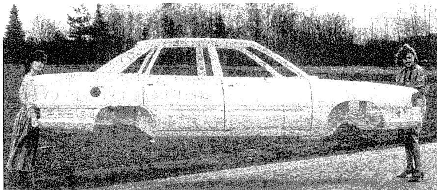
図4 ALCOA社とAudi社の共同開発によるアルミニウム合金製自動車ボディ
