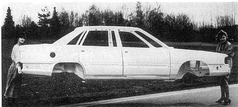
図5 Audi 100 アルミニウム合金製車体<sup>8)</sup>
