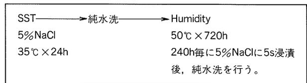
図18 糸錆試験方法
