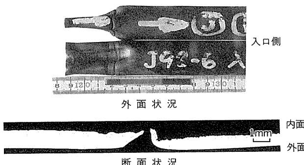
図10 図9の30%キュプロニッケル管と同一復水器で使用されていたアルブラック管に生じたアンモニアアタック(管装着位置: 凝縮部)
