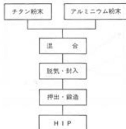
図 4 非封缶 HIP を用いた反応焼結法
