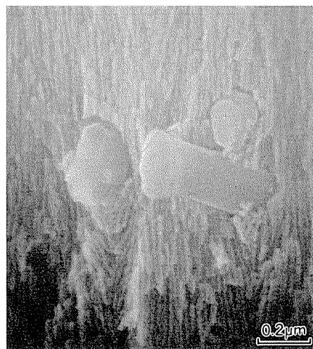
図4 硫酸浴陽極酸化皮膜中のSi粒子のSEM像
