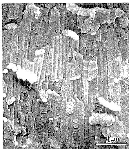
図21 SM11のスミトーン皮膜断面のSEM像
