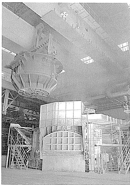
図3 溶解炉への材料装入
