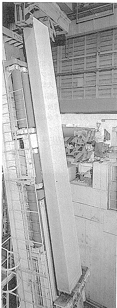
図6 新設備により鋳造された9mスラブ
