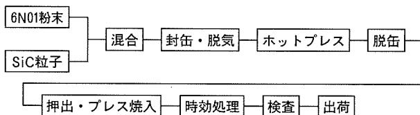
図23 複合材料によるリムの製造工程
