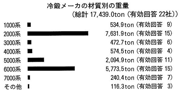
図2 アルミニウム冷間鍛造品の材質別生産量 (1989年度)<sup>1)</sup>
