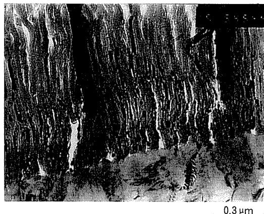
図2 二次電解着色皮膜断面のTEM像<sup>7)</sup>
