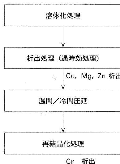
図2 7475合金の結晶粒微細化プロセス
