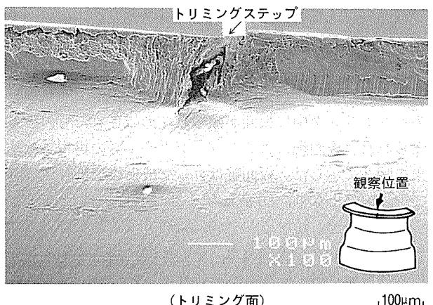
図6 トリミングステップにより誘発されたフランジクラック
